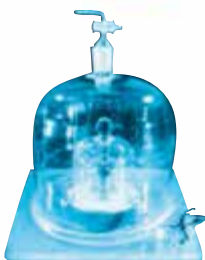
استاندارد ملی کیلوگرم نمونه دقیقی که از روی استاندارد جهانی برای ایران ساخته شده است.
